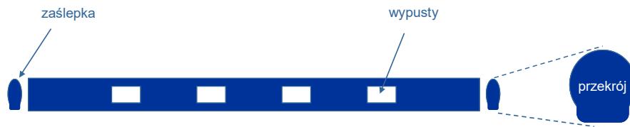
Rysunek 6. Diagram kształtu i przekroju rurki aluminiowej
